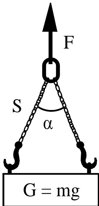
løftestropper av vaier eller kjetting og lastekrok. Både krok og stropper skal da være merket med største tillatte arbeidslast (SWL).
