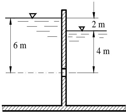
Fra en tank strømmer vann gjennom en åpning med areal  $A = 4 \text{ dm}^2$  og inn i en tilstøtende tank. Utløpskoeffisienten  $\mu = 0,62$ .
