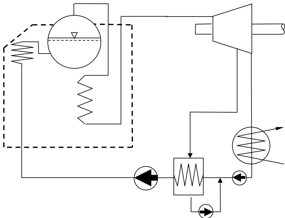
Et skipsdampanlegg med avtapping, som figuren over viser, har ved stasjonære forhold gitt:
