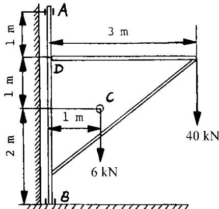
Figuren viser en svingbar kran. Den løfter en last på 40 kN.
