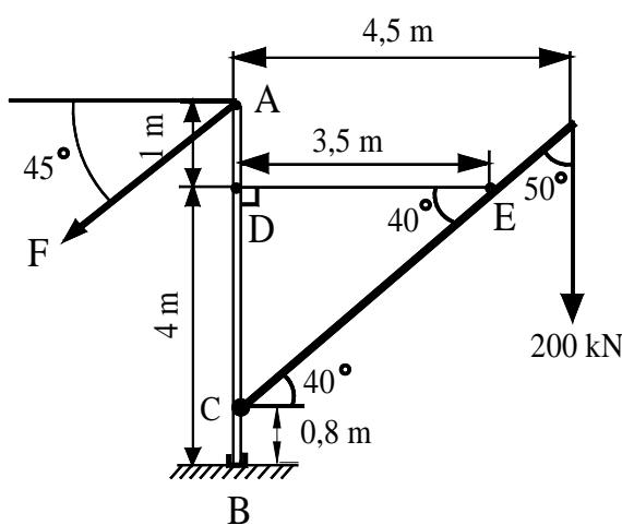
En svingkran har mål som vist på skissen. I A er det festet en bardun. Mastens tyngde er 10 kN og bommens tyngde er 5 kN.
